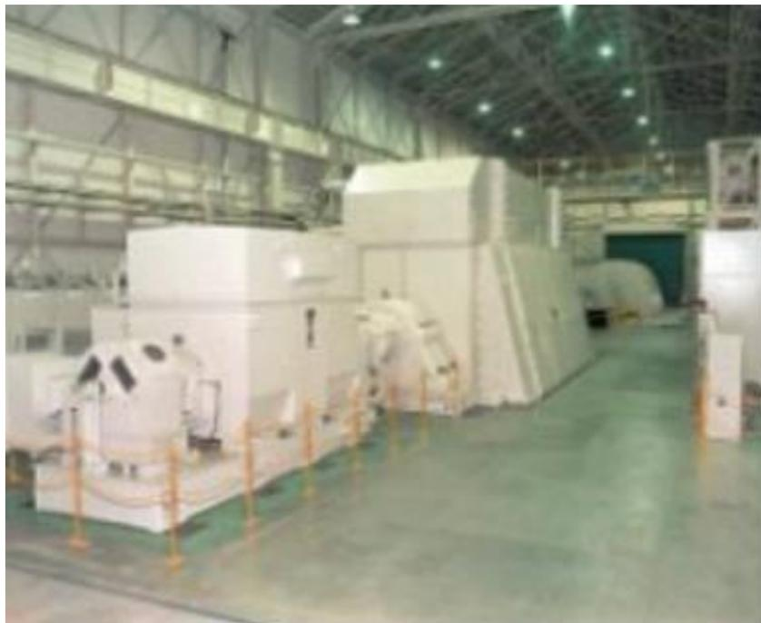
圖 8  $3\phi/18\text{kV}/180\text{MVA}$  短路發電機
