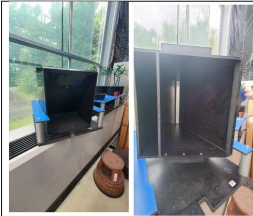
根系拍照盆，具有特製的斜面構造與排水空間。
