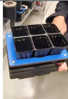
小型輸送帶系統載台，可適用不同盆具。
