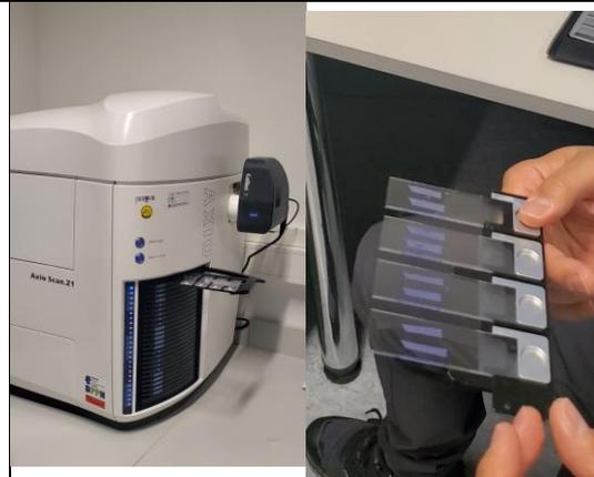
自動化玻片掃描系統(Zeiss Axio Scan.Z1)(左)，與染色後的玻片(右)。
