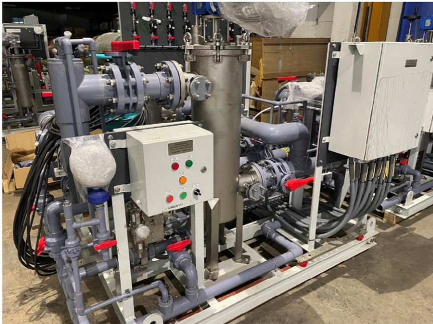
圖 13 Automatic and manual strainer skid 實拍圖
