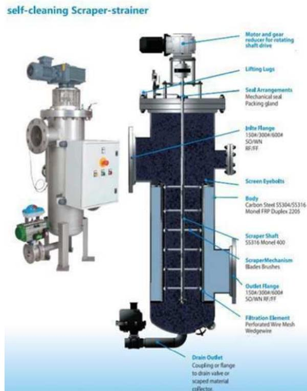
圖 11 過濾器(Scraper type)各部件圖
