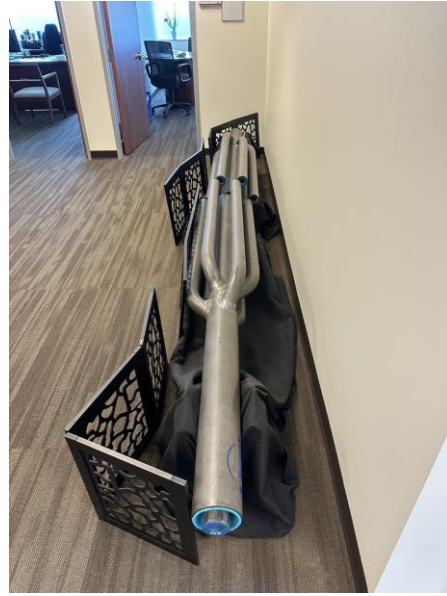
專利設備觸媒冷卻器新型換熱管
