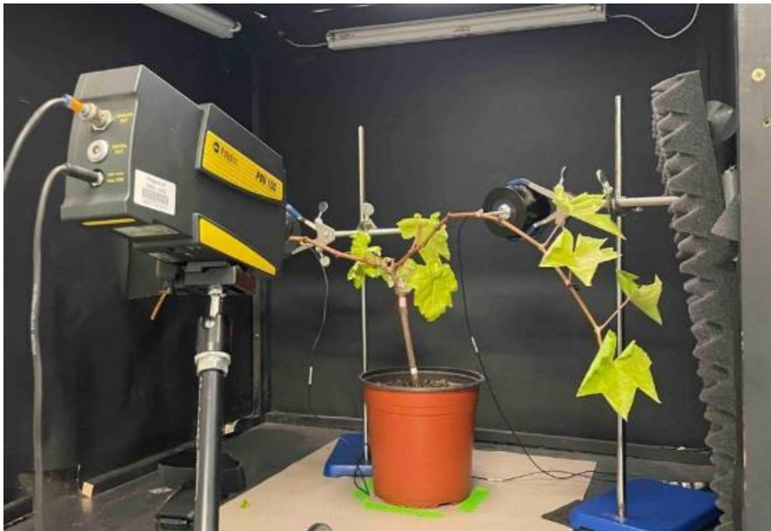
圖3、多點訊號回饋偵測試驗，環境設定，以及樹枝擺放，光源設置。
