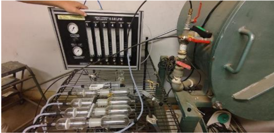
圖12、費洛蒙長效釋放技術之測試設備機台
