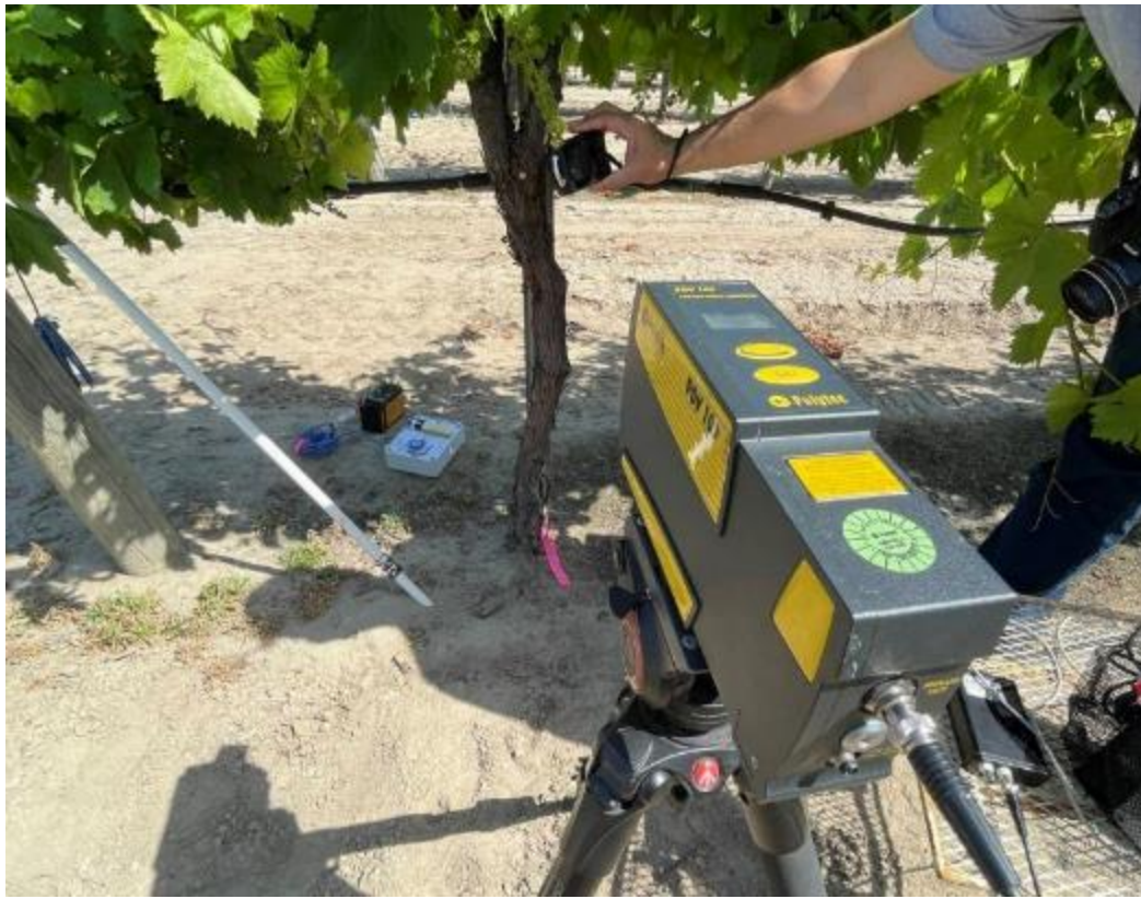
圖4、雷射振動儀器的田野試驗設置環境
