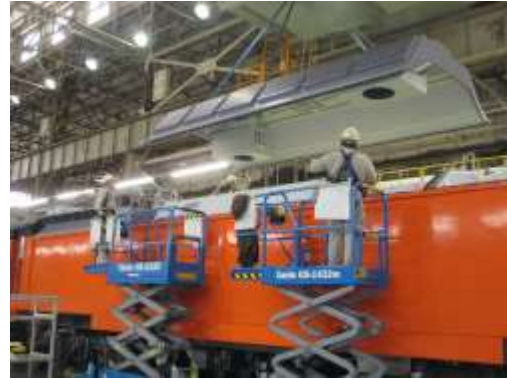
圖 3-66 機械室車頂安裝
