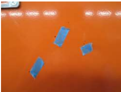
圖 3-6 標記油漆表面輕微瑕疵或髒汙待後續處理
