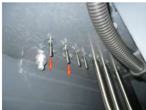
圖 3-7 由後端車下兩支排出管確認是否有執行排水動作
