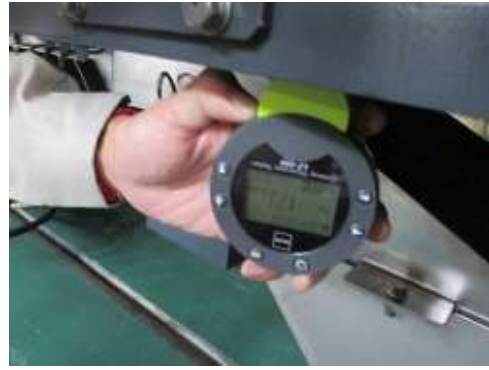
圖 3-5 油漆膜厚度測過程
