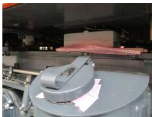
圖 3-13 砂箱砂重模擬用配重塊
