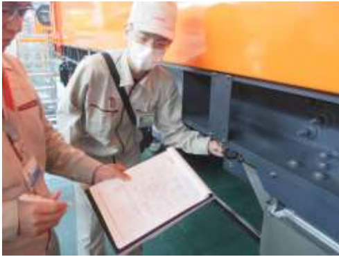
圖 3-5 油漆膜厚度測過程
