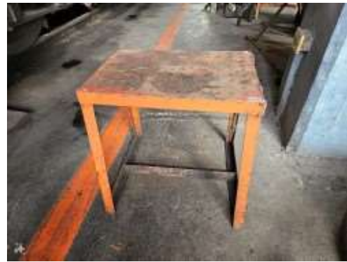
圖 5-6 本公司機坑車下作業用踏台
