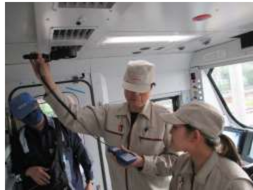
圖 3-24 出風口風量量測
