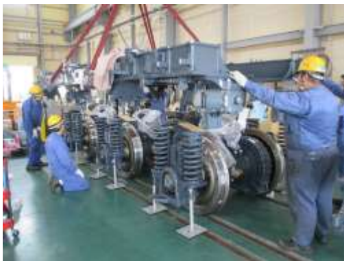
圖 3-73 轉向架與馬達輪軸組安裝
