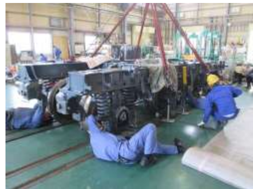
圖 3-74 轉向架與馬達輪軸組安裝
