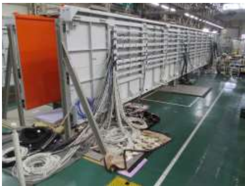
圖 3-61 側牆配線作業
