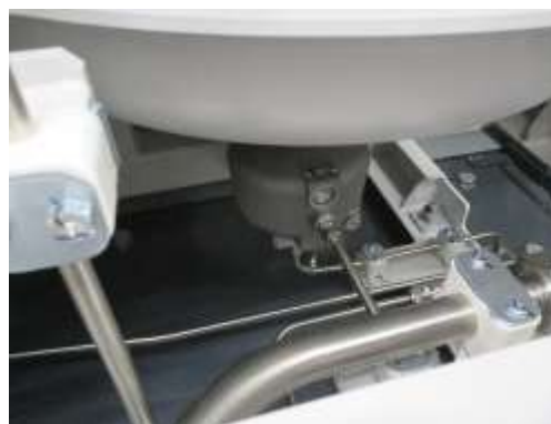
圖 3-8 主風缸自動排水閥
