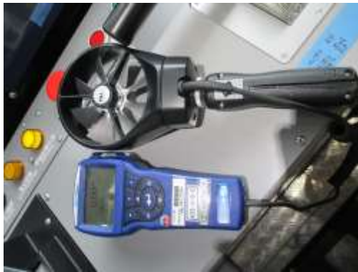
圖 3-23 扇葉式空氣流量計
