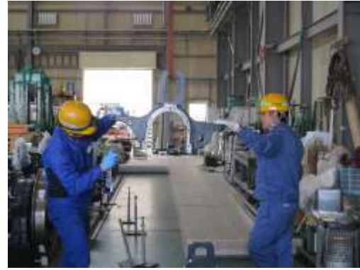
圖 3-70 軸箱安裝前檢視及清潔
