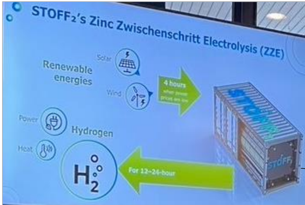
圖 12 Stoff 2 ZZE 系統運作方式
