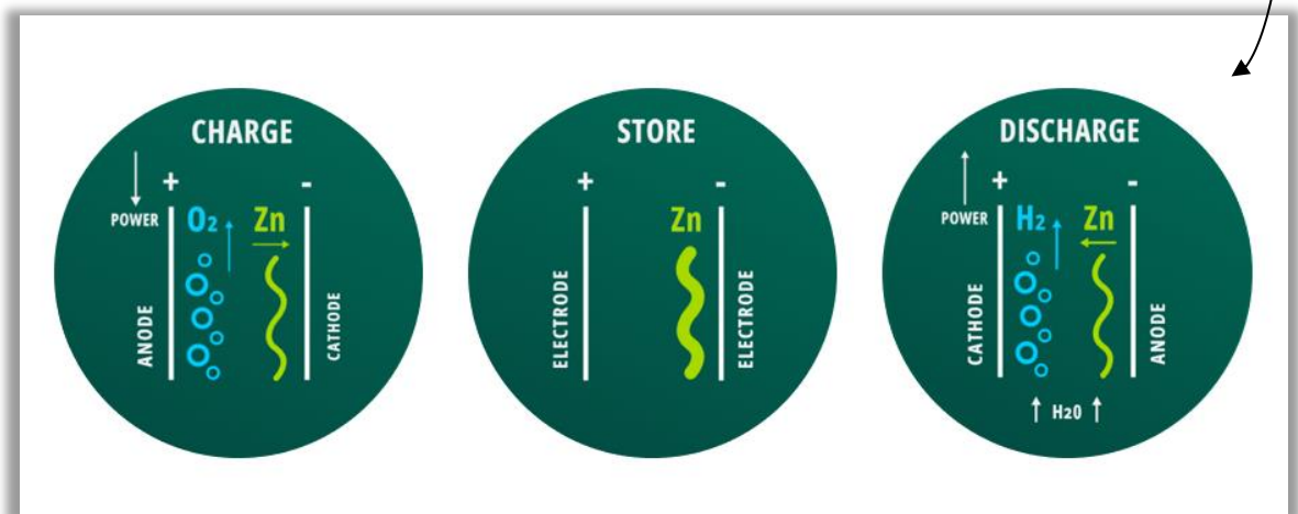
圖 13 設備內部儲電及放電之流程圖
