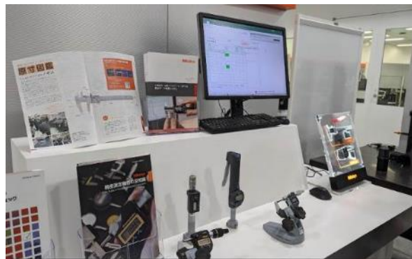
量測數值可直接傳送電腦鍵入，避免人工誤植
