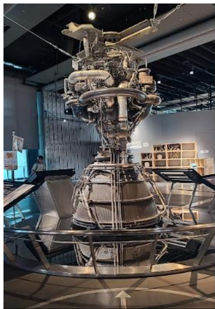
日本研發的二段燃燒火箭引擎，氫氧燃料的輸送幫浦都有標註實體展示
