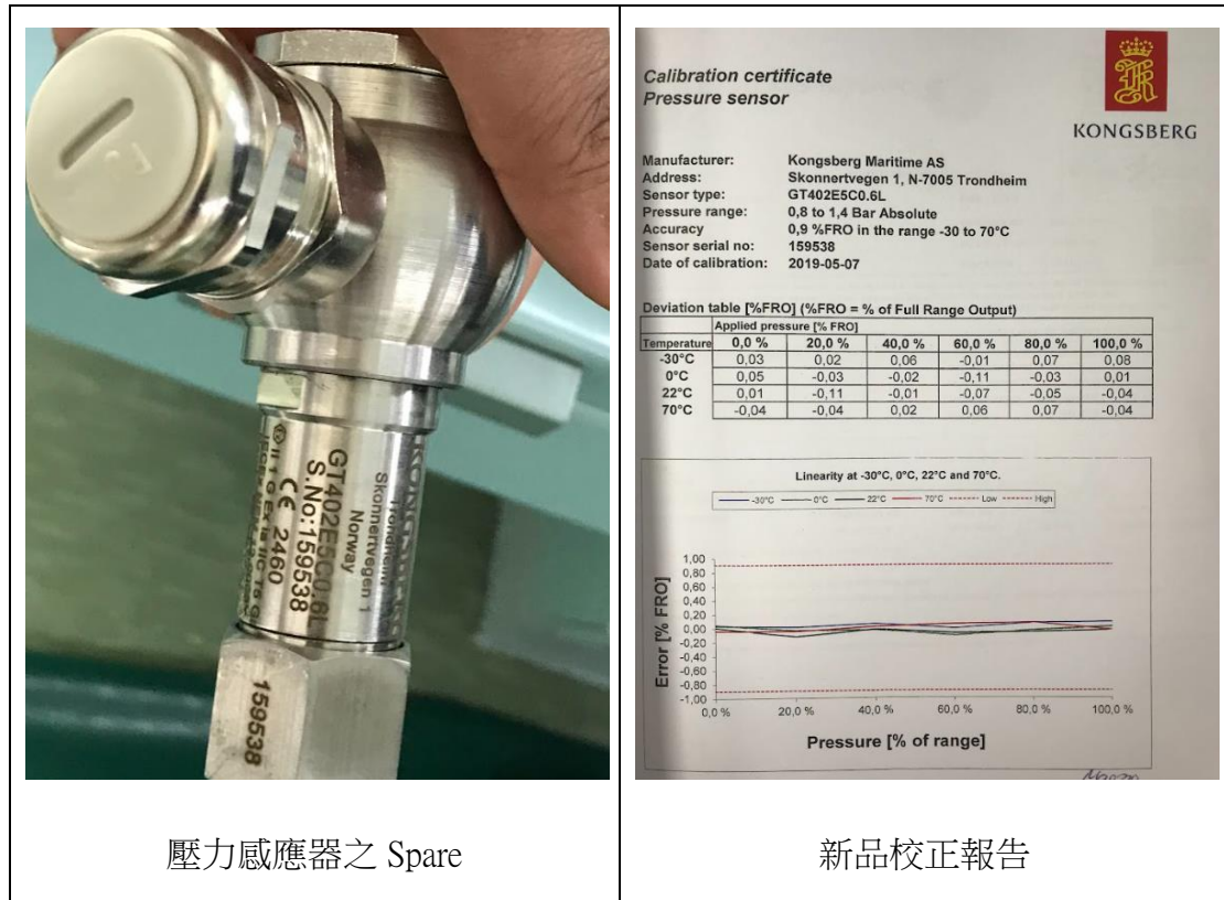
圖七、儲槽壓力計之備品及其校正合格報告
