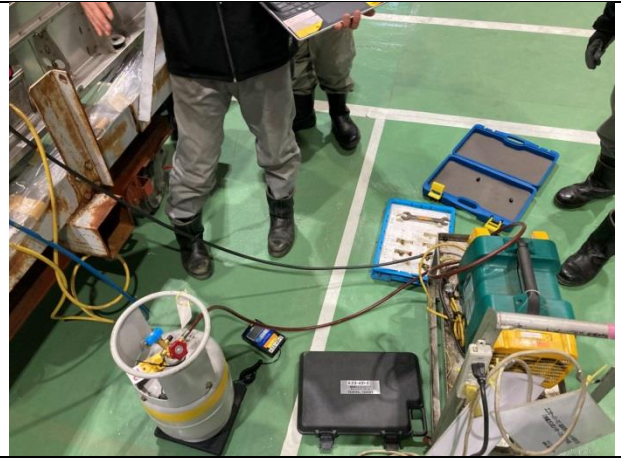
圖 159 空調機冷媒檢測介紹
