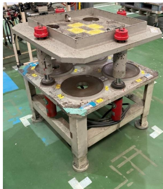
圖 108 轉向架重新組裝設備
