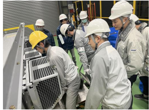
圖 2 牽引變流器分解、組裝方法說明
