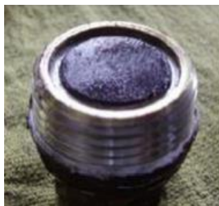
圖 79 供油栓・排油栓（附磁鐵）
