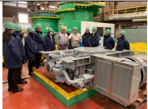
圖 8 主變壓器製造生產線實品確認
