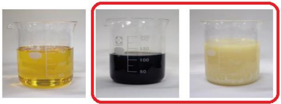
圖 83 潤滑油乳化·劣化
