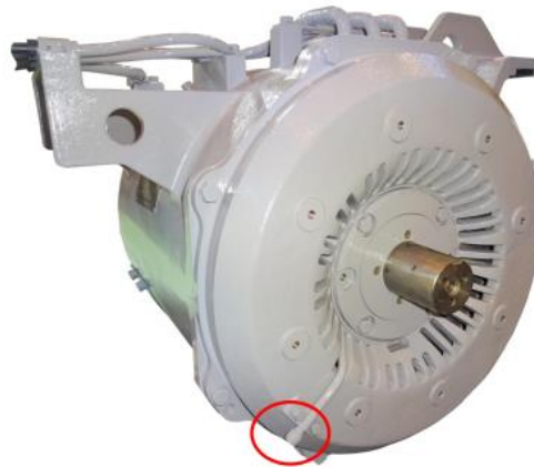
圖 66 中間軸承補充潤滑用潤滑脂蓋
