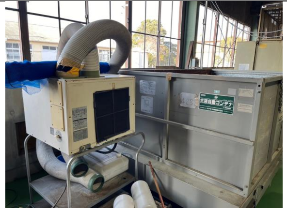
緑茶工場機械葉打(熱風吹葉機)
