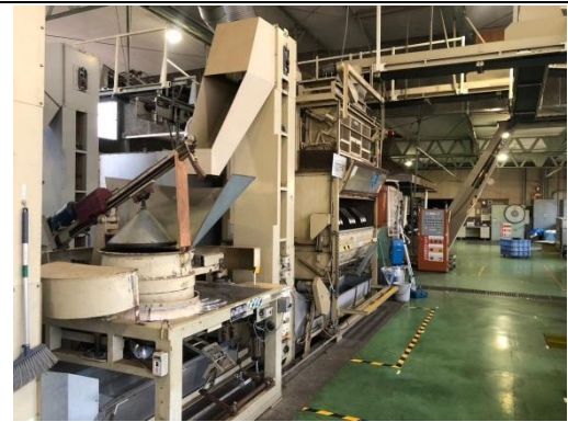
緑茶工場機械葉打(熱風吹葉機)
