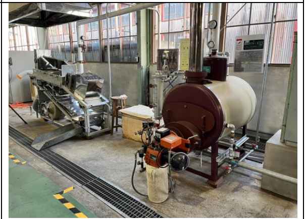
綠茶工廠小型試驗蒸菁機
