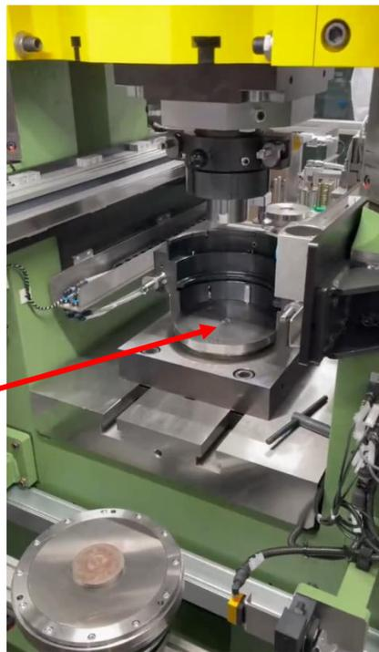
圖 6 下模座卸除後可進行退料頂桿更換
