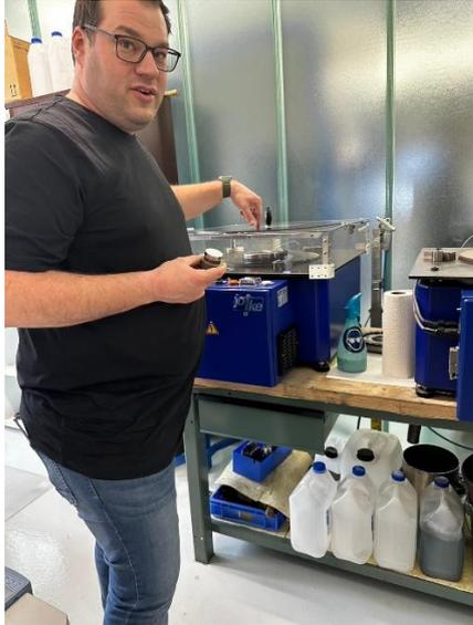
圖 22 使用平面拋光機拋亮模面
