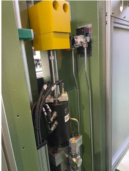
圖 10 防止沖壓頭落下安全裝置
