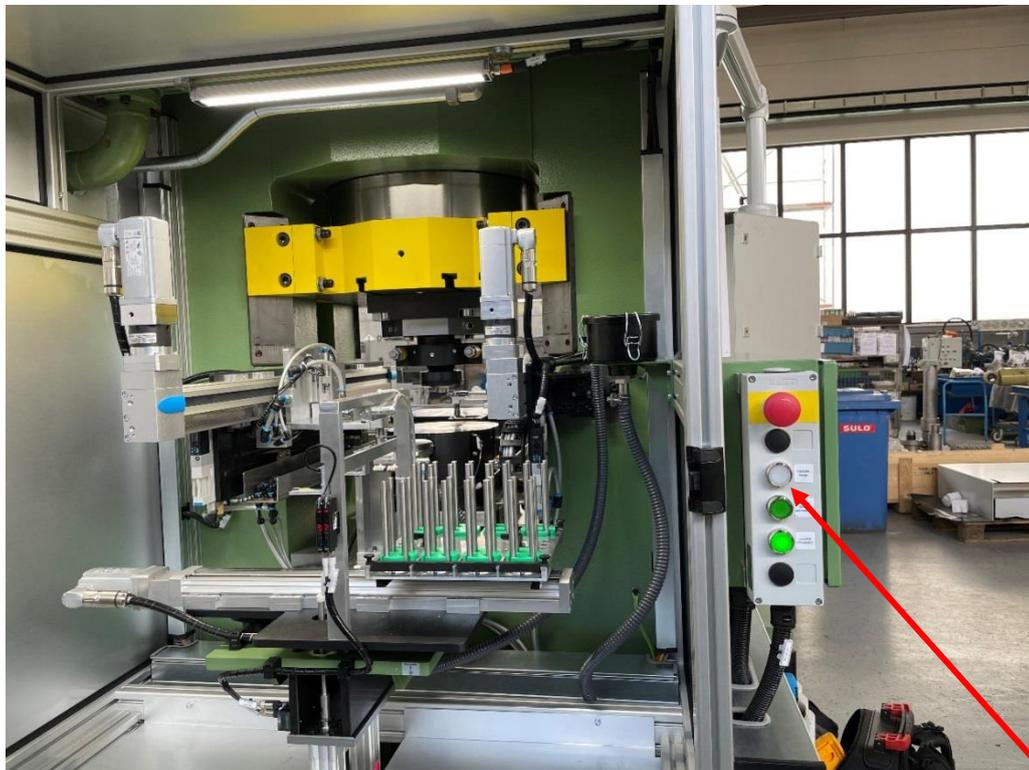
圖 12 背面安全窗開啟後可更換托料盤
