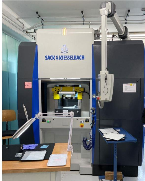
圖 21 TMP 450 自動化液壓印花機
