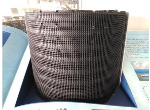
圖 3.3.9 滲透取水裝置之集水管構造
