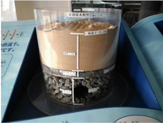
圖 3.3.8 浸透取水設施斷面說示意
