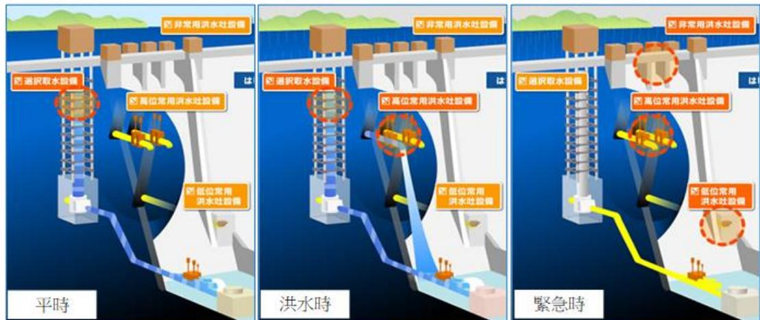
圖 3.4.19 宮瀨水庫各階段放水流程
