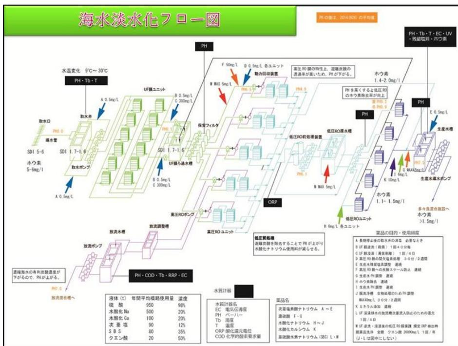
圖 30 海淡場系統流程圖及機械槽體規格
