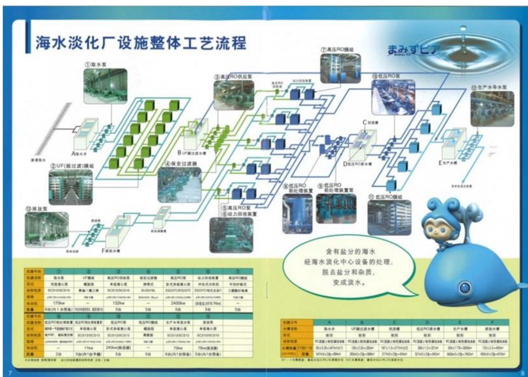
圖 31 海水淡化處理流程图(含加藥系統)
