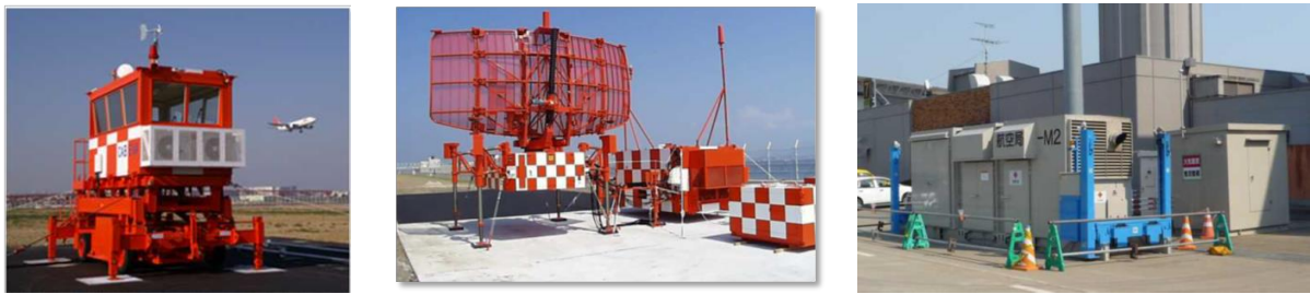
圖 11 日本三大機場（羽田、關西、福岡）緊急備援塔臺、行動雷達站及可移動式發電機
