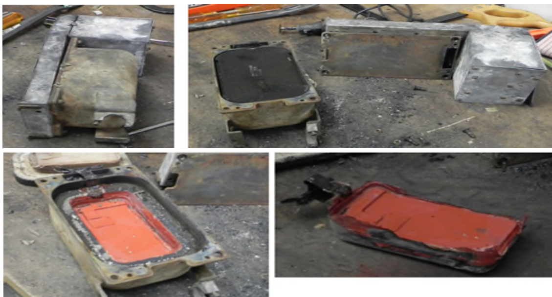
圖 6 極端高熱損毀之紀錄器
