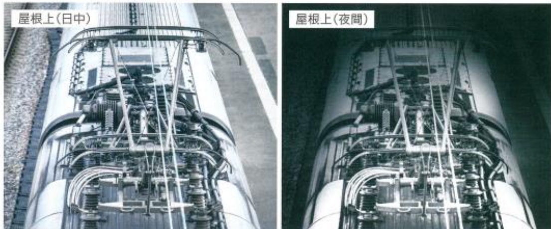
圖 3-7 集電弓檢查裝置之拍攝影像
