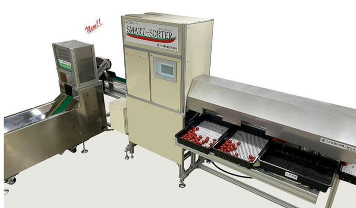
圖 1-10 透過光照波長判定水果甜度及重量分級測試機
