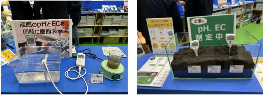
圖 1-13 水耕養液及土耕栽培介質之 pH 及 EC 檢測技術、設備
