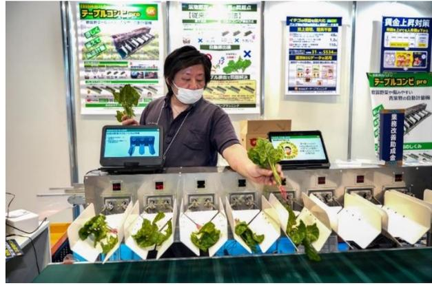
圖 1-8 重量測量分檢機
