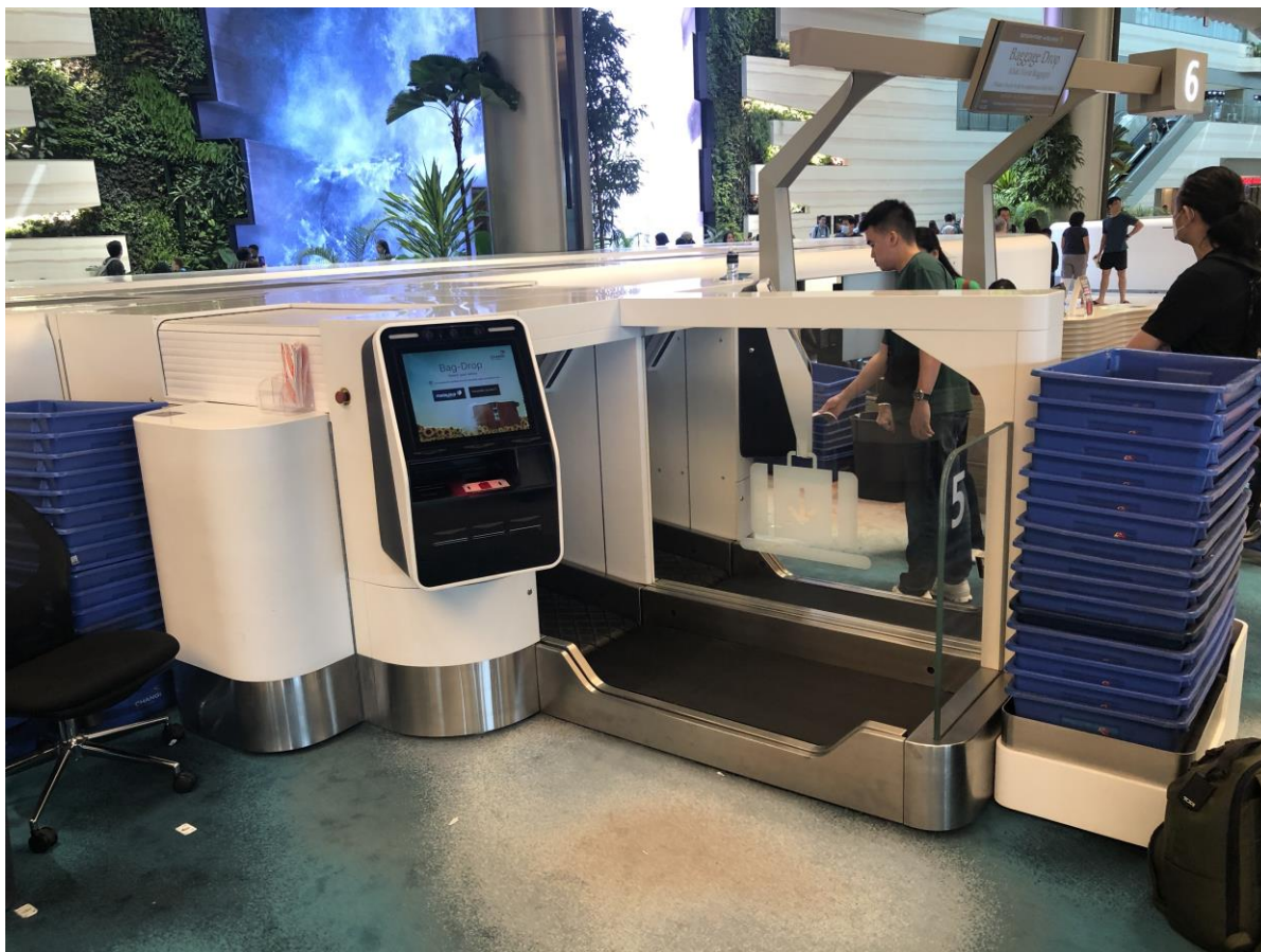
圖 3-6 樟宜機場混合型 SBD 設備
