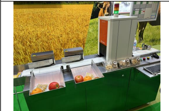
67. 光學分級機(具瑕疵辨識剔除功能)。
