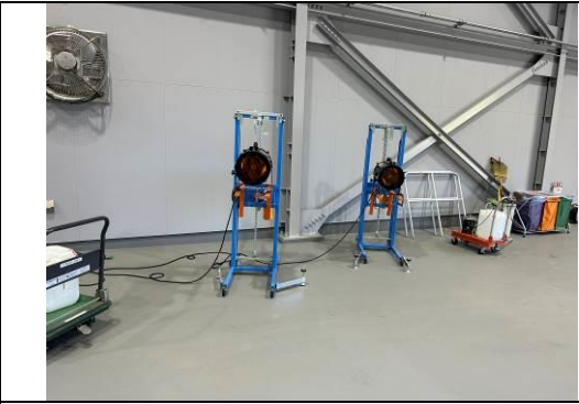
24. 光學感測設備—強逆光測試器材。
