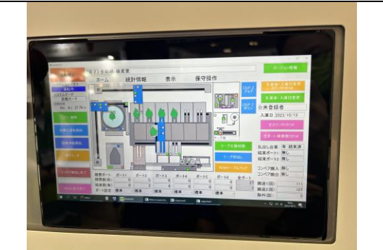
66. 具動態顯示之紫蘇分級機介面。
