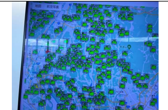
14. 系統顯示故障農機資訊(左方紅點)。
