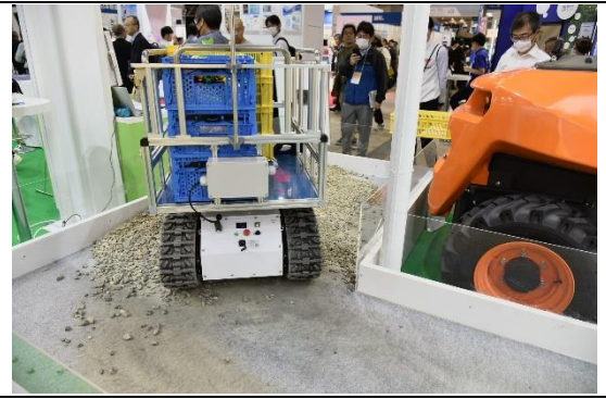
72. 遙控式田間搬運機越野性能演示。
