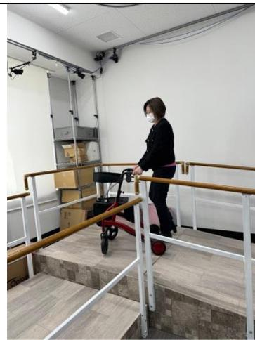
電動輔助助行器感應使用者鬆手時會煞車停止，且助行器翻落時，有警示聲請求協助
