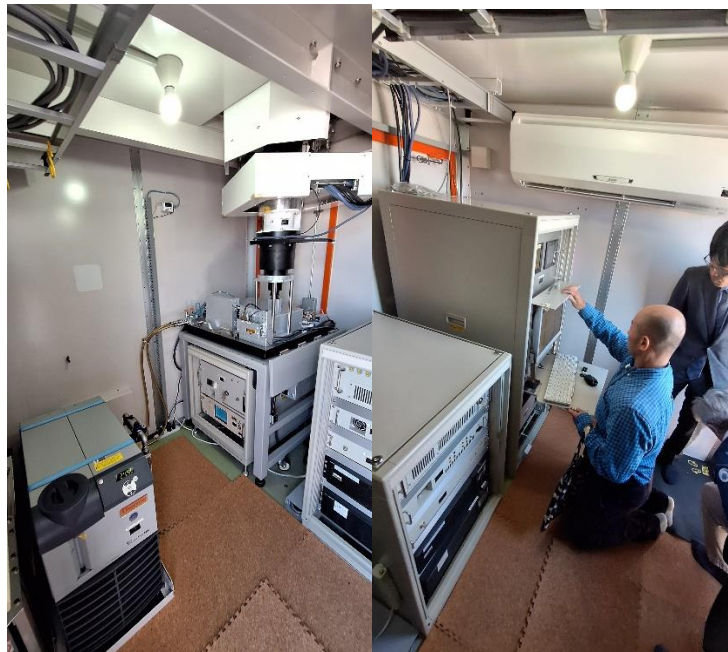
圖 18：(左)光達本體、水冷設備、電源設備；(右)操控電腦、資料處理伺服器主機、冷氣空調設備。(實地拍攝照片)
