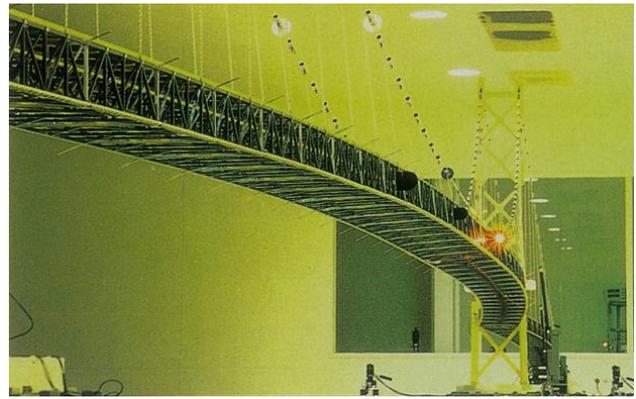
明石大橋比例尺 1/100 模型與風洞試驗
