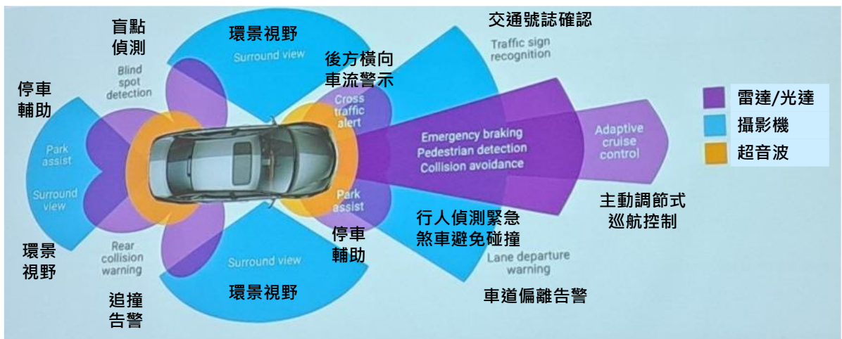
圖12 自動駕駛系統偵測系統、多重化及複雜性偵測功能示意圖
