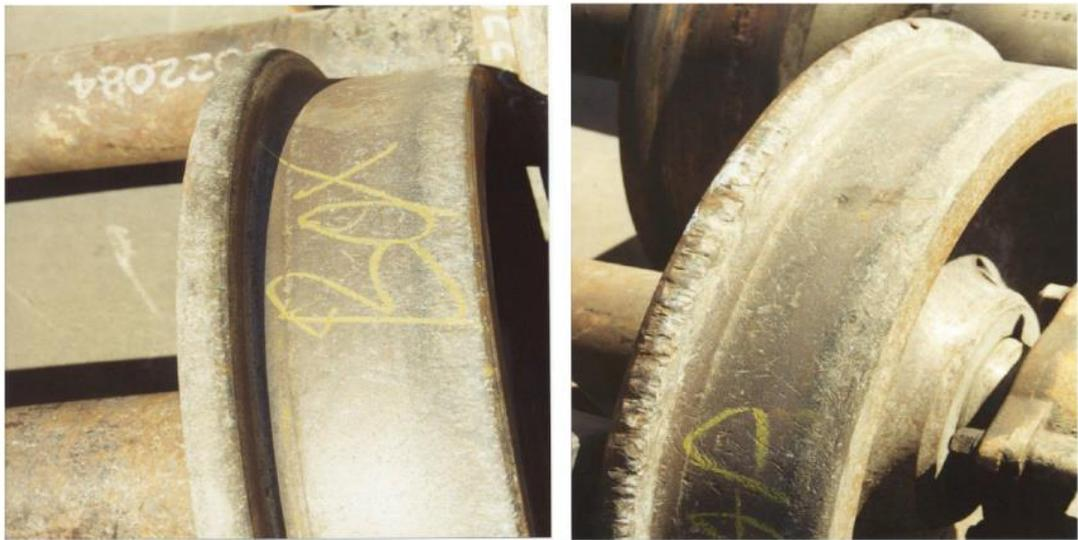
圖 19 道碴中運行造成輕微損壞及在扣件上運行輪緣嚴重受損
