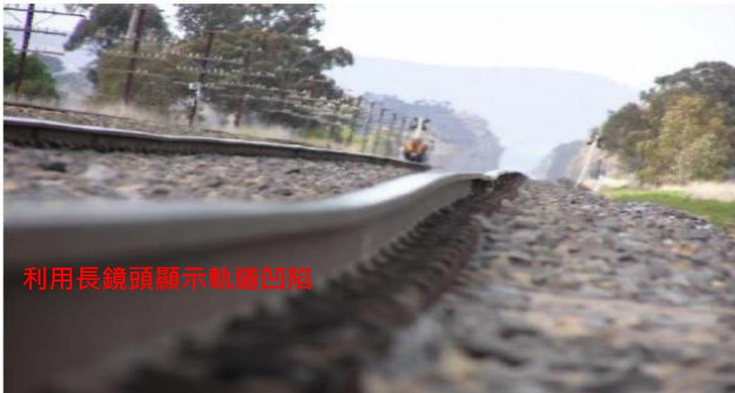
圖 11 利用長鏡頭顯示軌道凹陷
