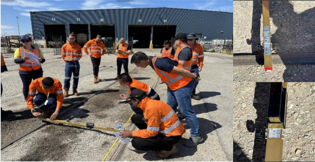
圖 16 出軌點前 60 公尺及脫軌後 20 公尺量測
