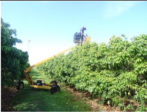
圖52.荔枝高空採收作業機械
