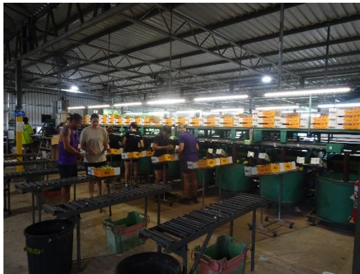
圖18.芒果自動分級機及人工裝箱作業
