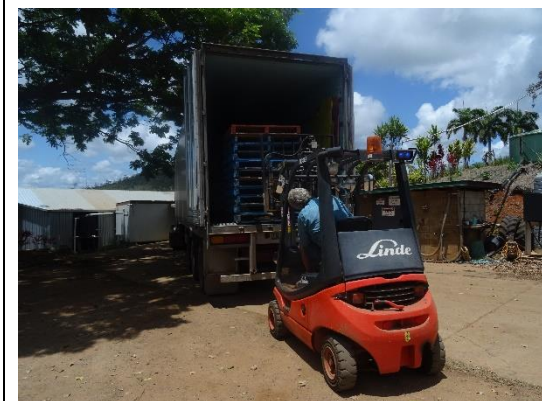
圖32.堆高機搬運棧板並測試貨櫃寬度
