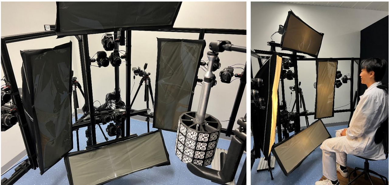
Fig. 7b. 顏面掃描系統 Medusa system。包含 12 台高機能數位相機與三維條碼定位器
