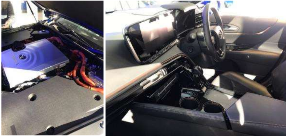
圖 22 TOYOTA-MIRAI 燃料電池構造與內裝
