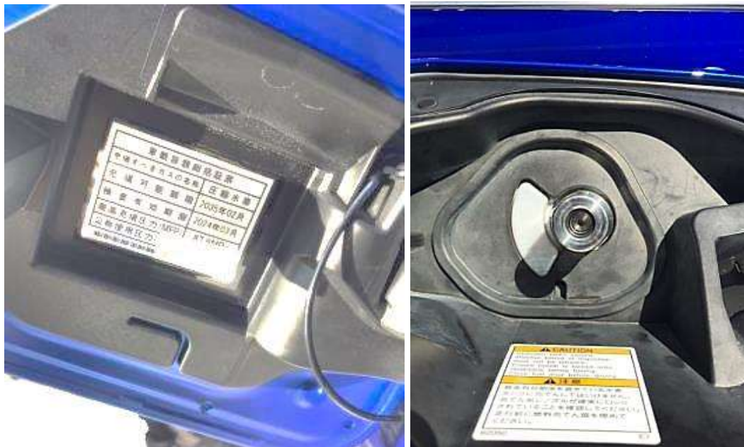
圖 23 TOYOTA-MIRAI 加氫規格（壓力與檢查期限）與管口構造
