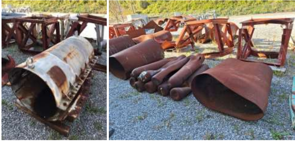
圖 4 大型槽體與氣體鋼瓶在耐爆測試後之廢材
