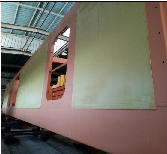
防鏽漆施作工程
