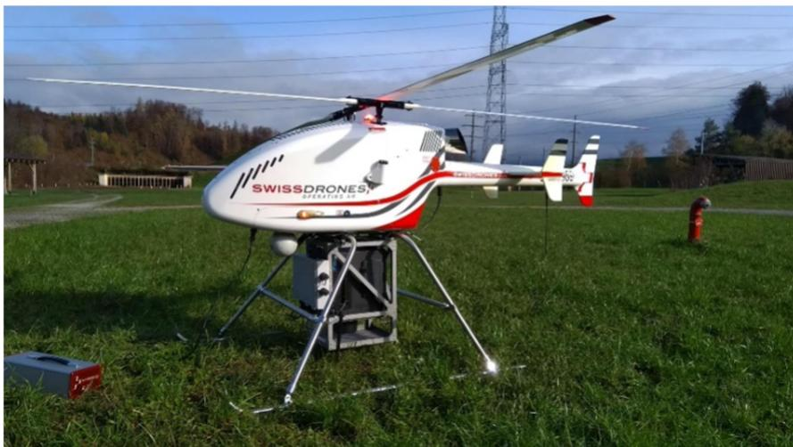
圖 83：SWISSDRONE SDO 50 v2 汽油引擎無人機與 HPGe 偵檢器
