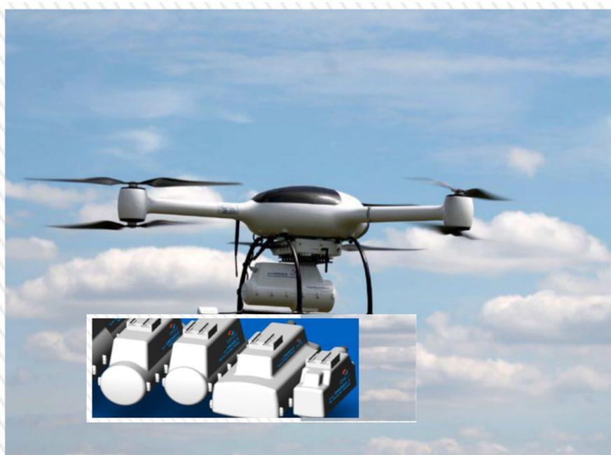
圖 85：NuEM 無人機同時搭載多種類型的偵檢器
