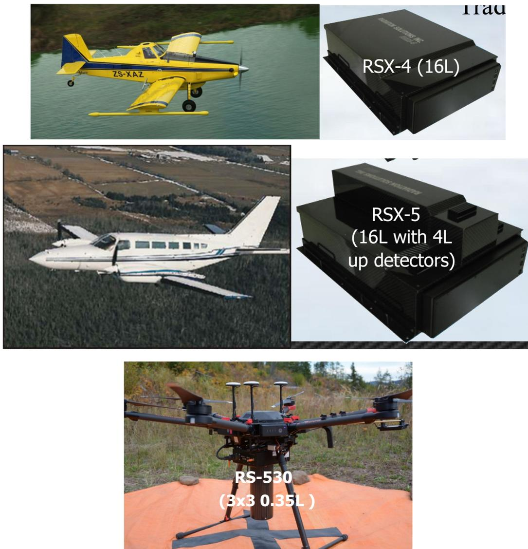
圖 66：3 種飛行載具與偵檢器的最佳組合
