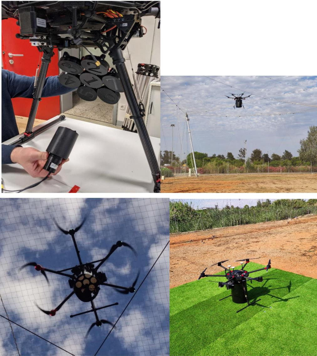
圖 95：DJI M600 pro 搭載無人機 UVC 組成簡單系統的戶外測試
