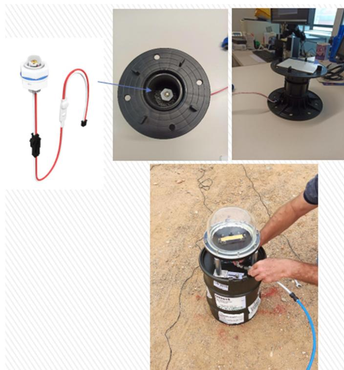
圖 93：5 個 LED 紫外線燈所含 UVC 組成的簡單系統
