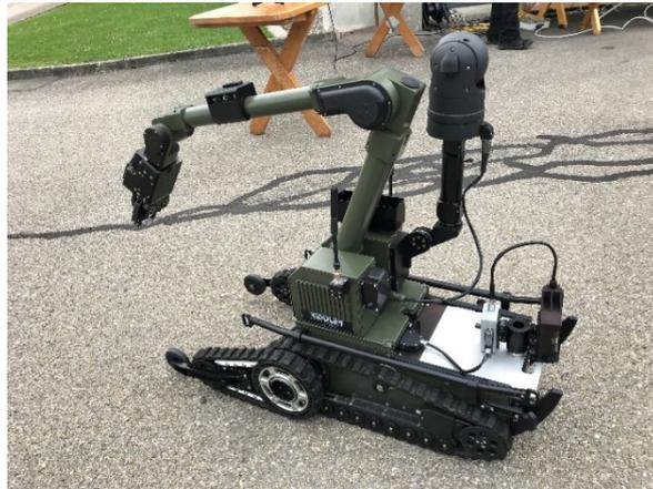
圖 99：履帶式中型偵測車
