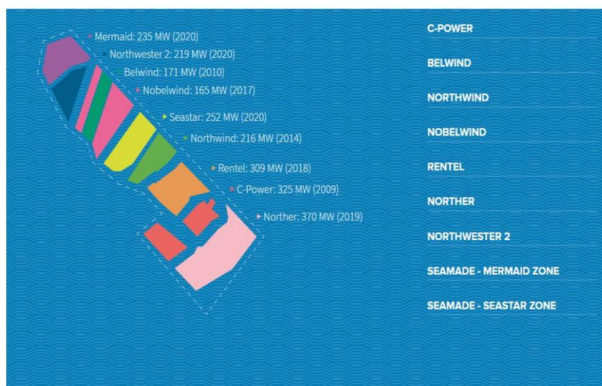
圖 6 比利時已開發之離岸風電專區區（計 2,262MW）
