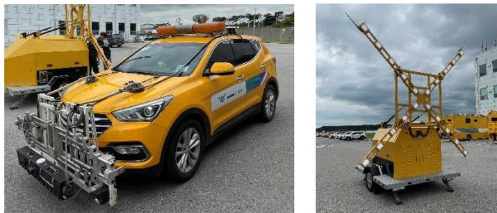
圖 3.14-3 仁川機場燈光檢測車（左）及跑道關閉標誌車（右）
