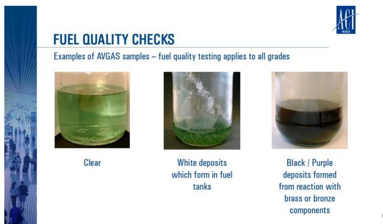
圖 3.11-3 航空燃油取樣對照示例
