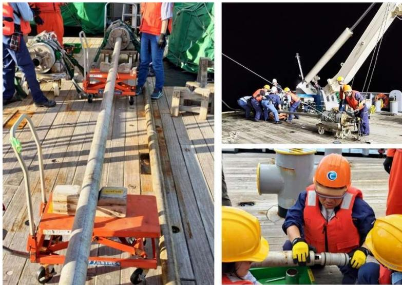
圖 18、白鳳丸的活塞式岩心是用船後 A 架將岩心帶上船，甲板所空長度外即為一般岩心所能採集的長度
