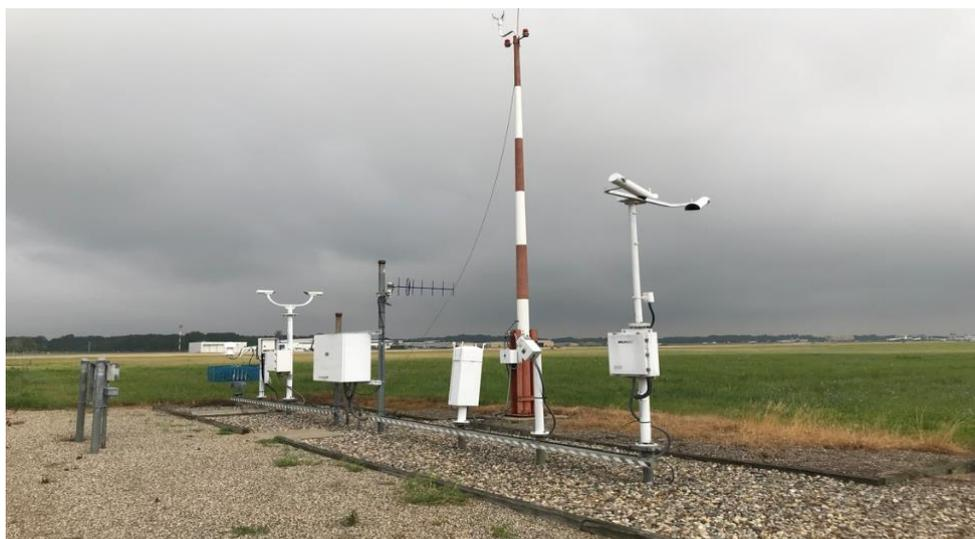
圖 16- 美國機場 Auto METAR 自動觀測氣象儀器
