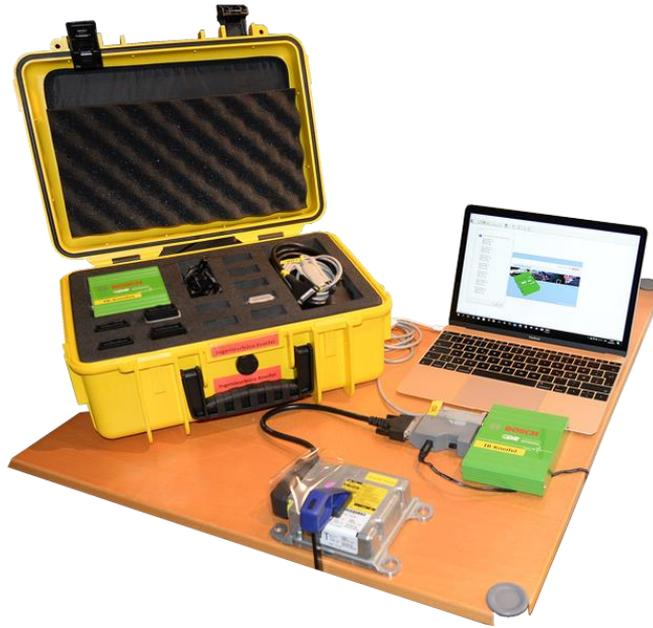
圖 3-1 EDR 資料下載接線示意圖
