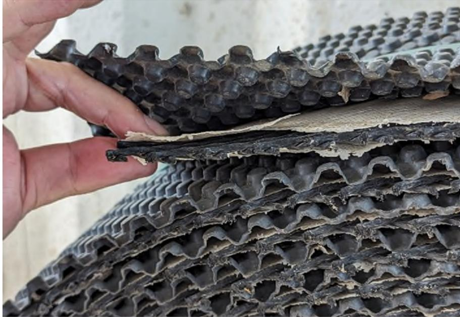
圖 40、MABR 卷式生物膜內部詳細構造
