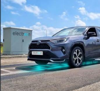
圖 49、無線充電道路線圈模組及動態充電示意（資料來源：ElectReon 簡報）
