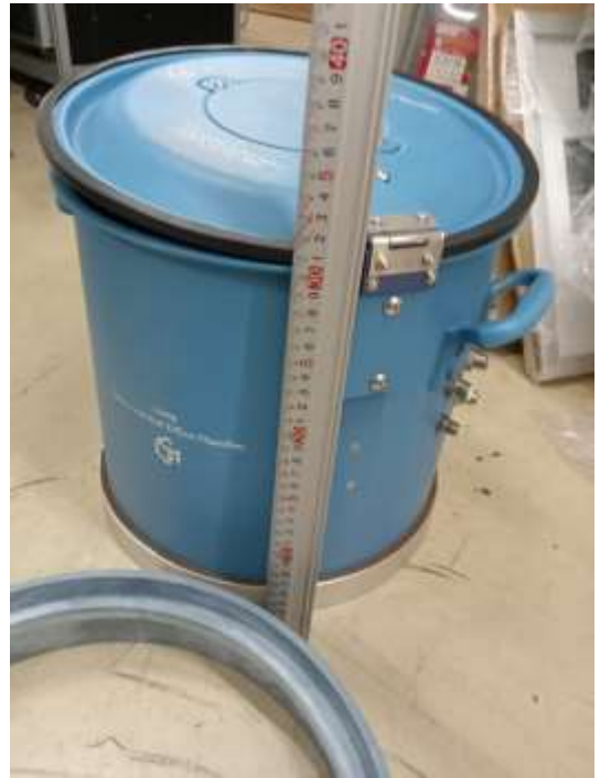
圖二十八、攜帶型密罩尺寸與底座。
