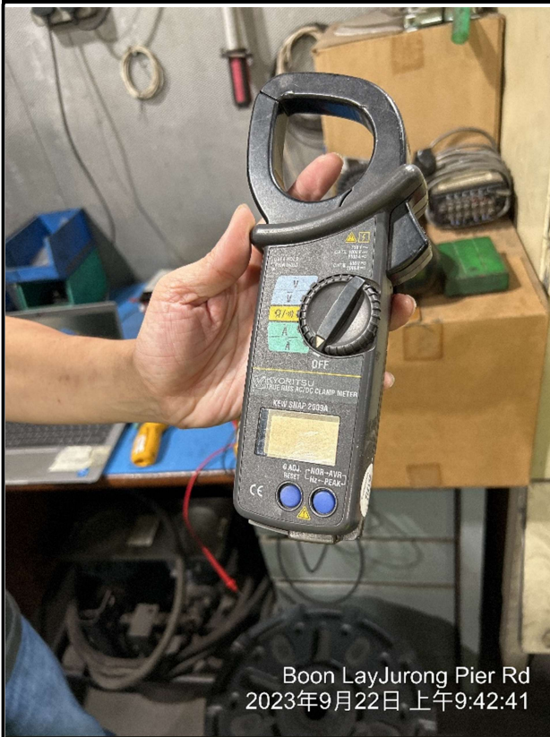
AC 電流鉤錶 (AC 電壓最大偵測值 750V，電流最大偵測值 2000A)
