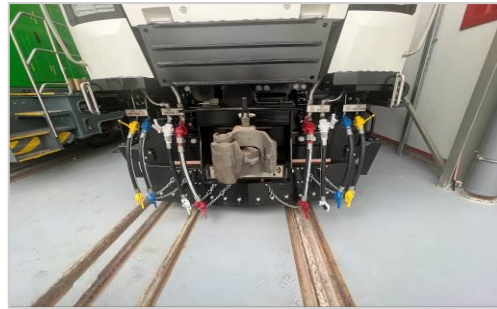
圖 18 R205 連接器與空氣軟管檢驗
