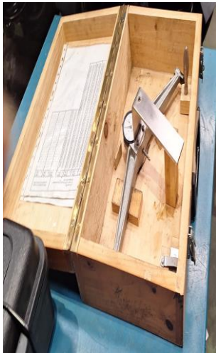
圖 93 柴電機車輪徑規
