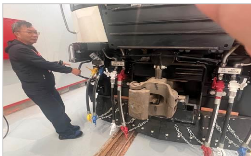
圖 29 解鎖拉桿開度檢驗
