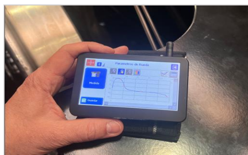
圖 50 PDA 以圖形顯示輪胎尺寸
