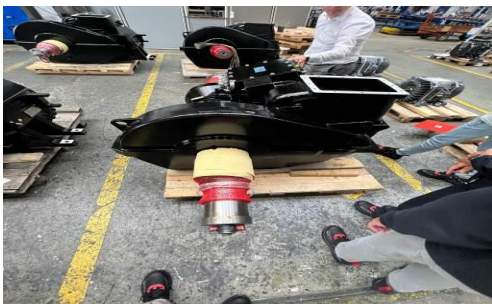
圖 9 馬達與車軸總成未檢驗
