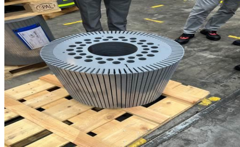
圖 6 已完成加工 TM 轉部
