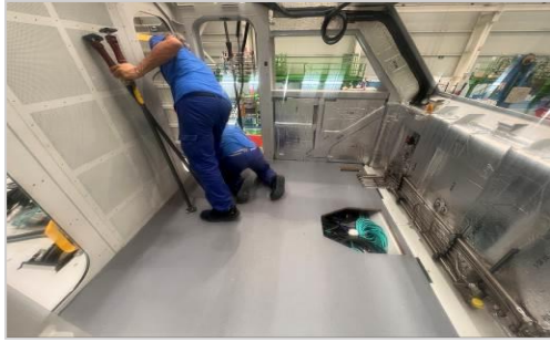
圖 27 駕駛室內裝施工
