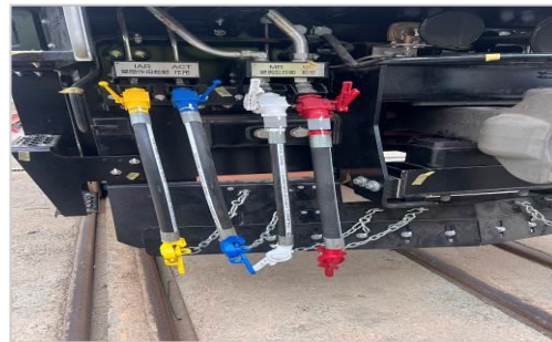
圖 40 車頭空氣軟管啞接頭檢驗
