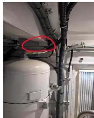
圖 73 檢視車內有滴水情形
