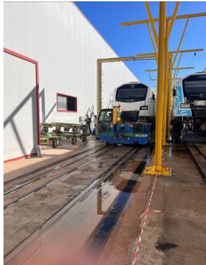
圖 70 移動式水密試驗
