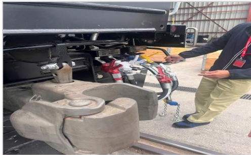
圖 37 解鎖拉桿開度檢驗
