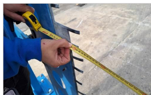
圖 44 車輛界線量具尺寸檢驗
