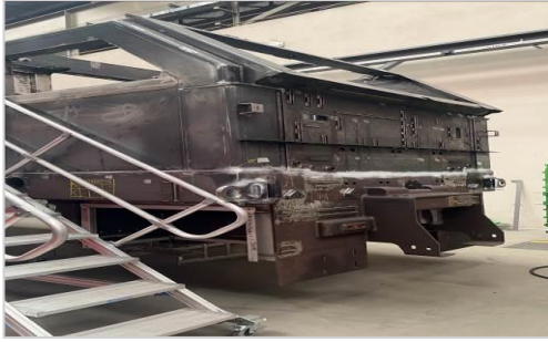
圖 31 駕駛室本體焊接進度檢驗
