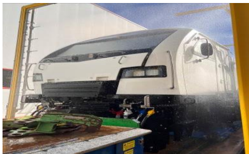
圖 57 車廂水密動態試驗
