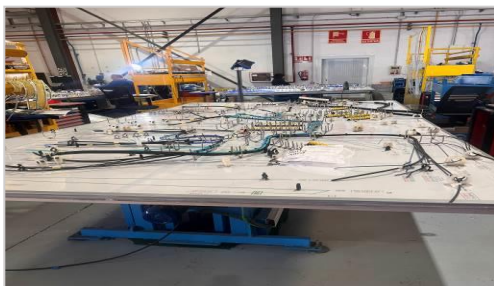
圖 33 模擬板配線作業
