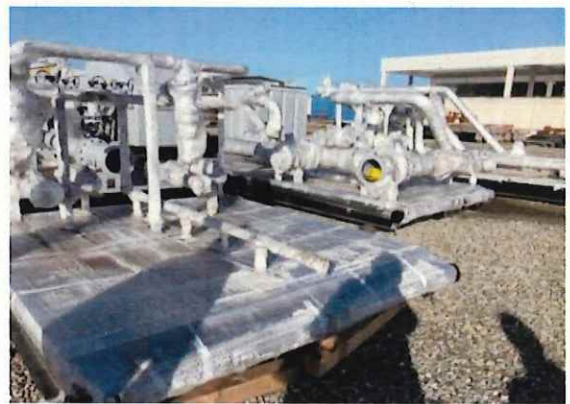
圖 18、CPC-10BW06 第 2 套鑽機泥漿歧管
