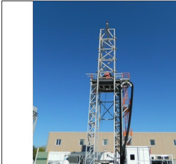
圖 6、頂驅、鑽機等設備出廠前測試
