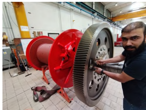
圖 19、講師講解 Drawworks 內部機械構造
