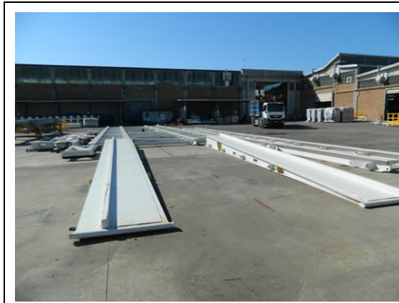
圖 8、HH220 的底座滑軌系統(skidding system)
