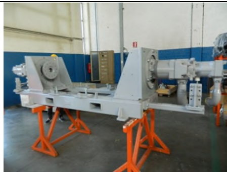
圖 16、HPU 主液壓泵產線廠驗
