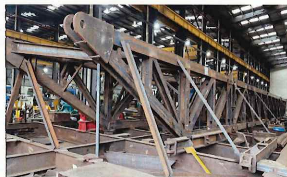
圖 4、CPC-10BW04 井架製造(供應商處)
