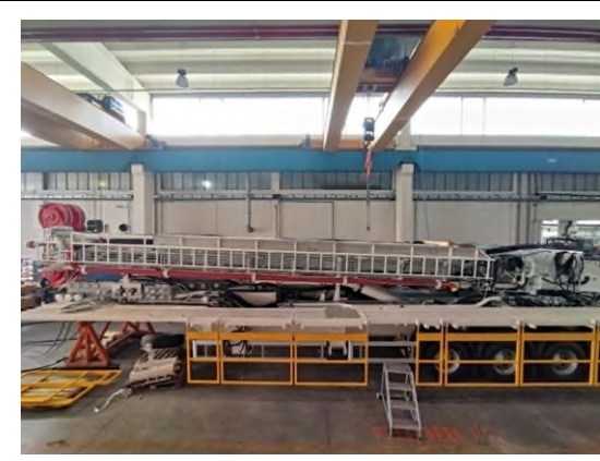
圖 11、車載升降系統與伸縮式井架連接作業
