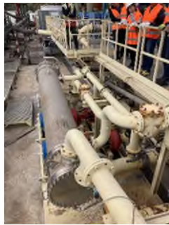
圖 40、泥漿冷卻系統的熱交換器（銀色），內有蛇形管供泥漿流動。
