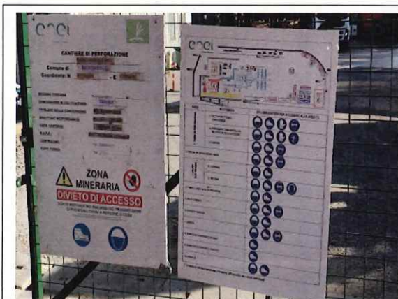
圖 22、進入井場相關安全規定告示(不同區域所須配戴之 PPE)
