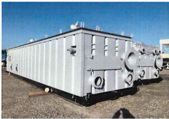
圖 17、CPC-10BW06 第 2 套鑽機泥漿吸罐
