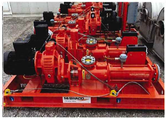
圖 16-2、CPC-10BW06 泥漿處理設備(供應商處)
