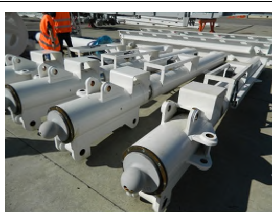
圖 9、Skidding system 之主要液壓缸
