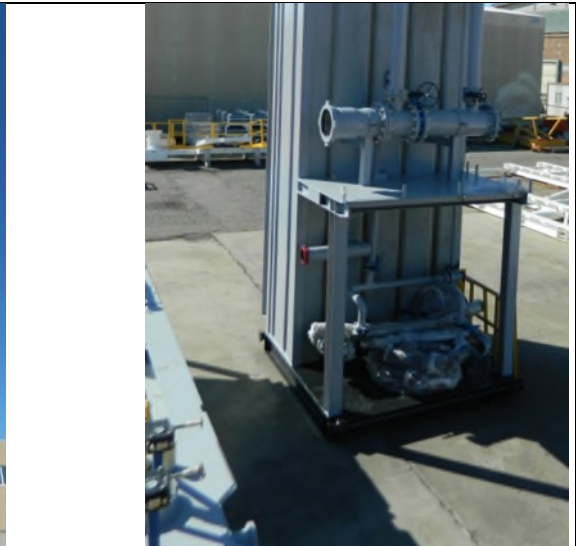
圖 7、Trip Tank 設備可用於防噴預警
