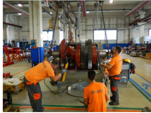
圖 23、深入瞭解泥泵內部構造及組裝流程
