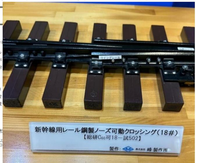
新幹線用鋼軌之新形式鼻軌可動式岔心
