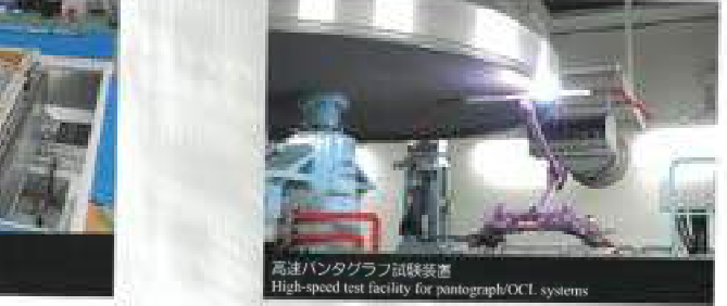
高速パンタグラフ試験装置 High-speed test facility for pantograph/OCL systems
