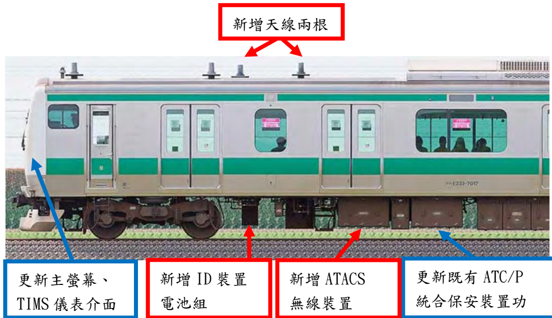
圖 17 E233 系 7000 番台 ATACS 車載設備改裝概要[6]
