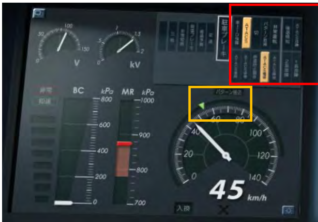
圖 18 導入 ATACS 之列車主螢幕：紅框為 ATACS 運轉狀態顯示 黃框為經 ATACS 運算出速限及接近減速曲線提示燈[7]
