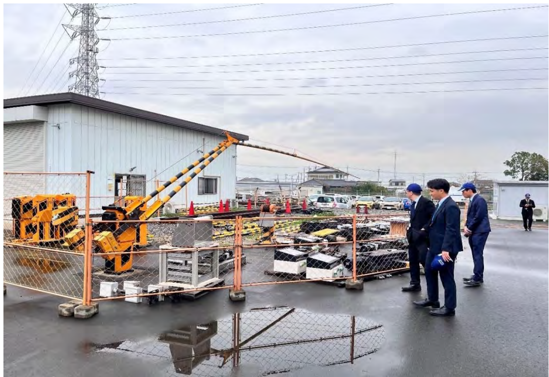
圖 64 日本信號公司平交道系統耐久性測試
