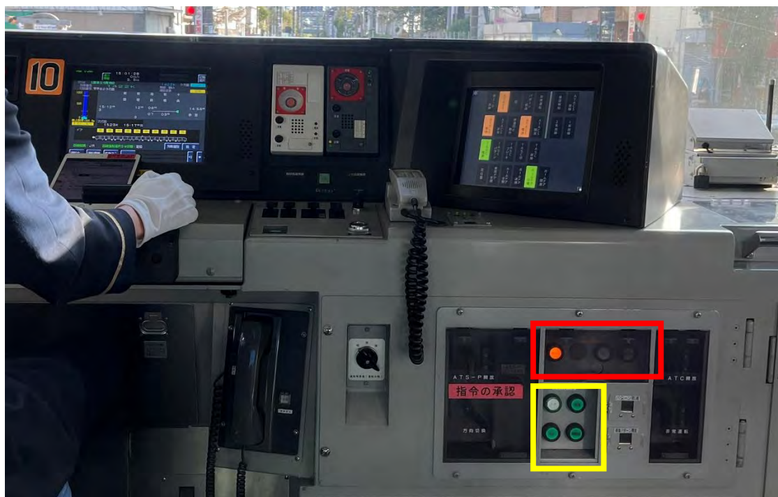
圖 21 紅框為保安系統實體切換按鈕 黃框為列車等級狀態指示燈
