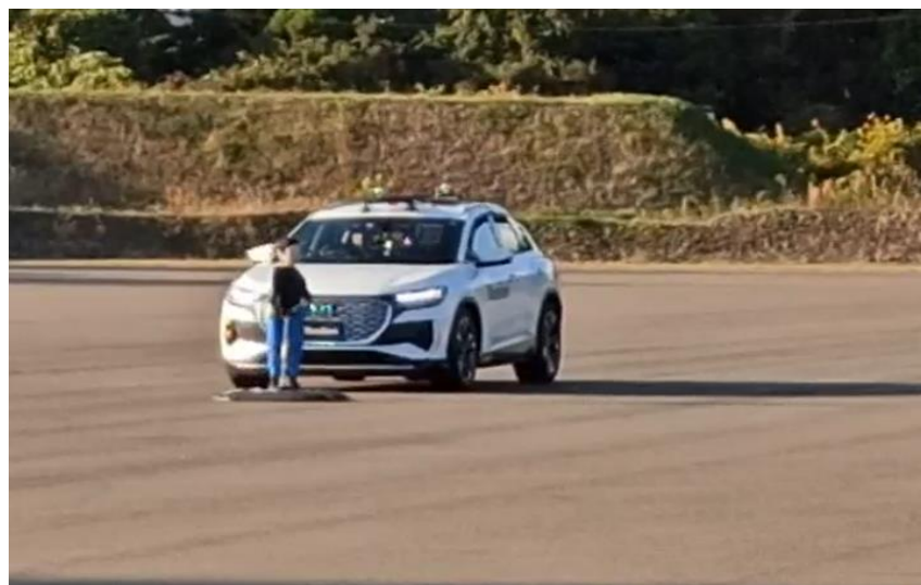
圖 8. JARI 城里測試中心 ADAS 測試場的行人與車輛緊急煞車測試測試
