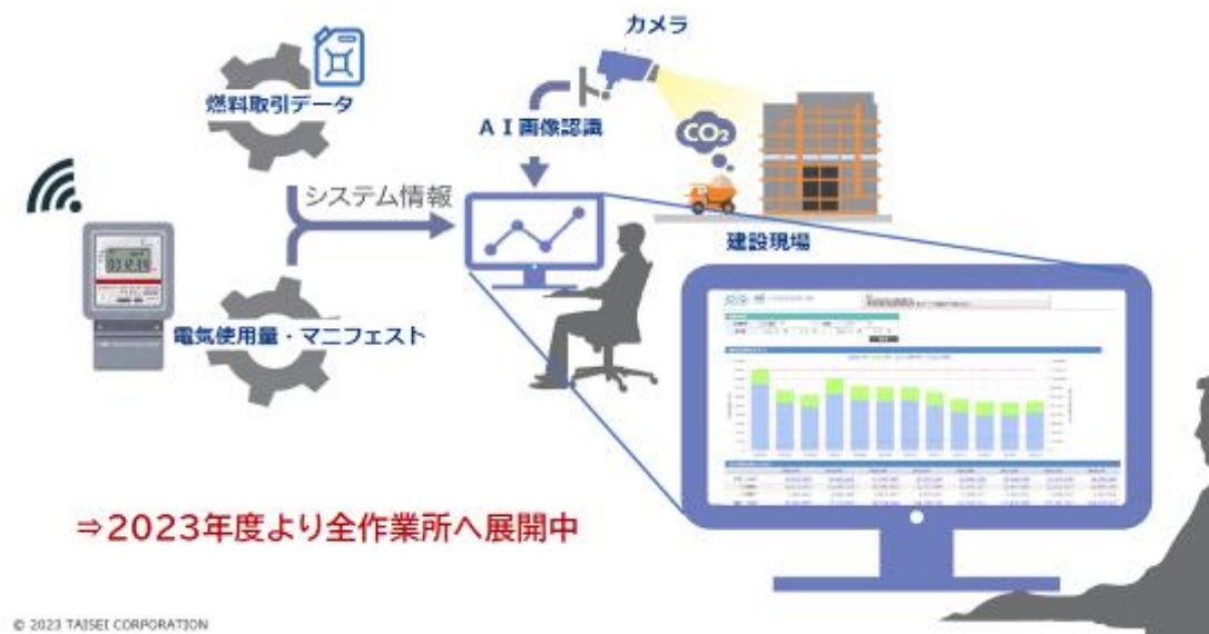
圖 79 建築工地 CO 2 排放測量和匯總系統 1
