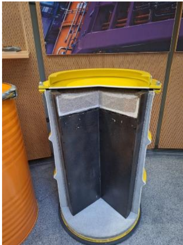
圖 30：最終處置桶內容物剖面構造
