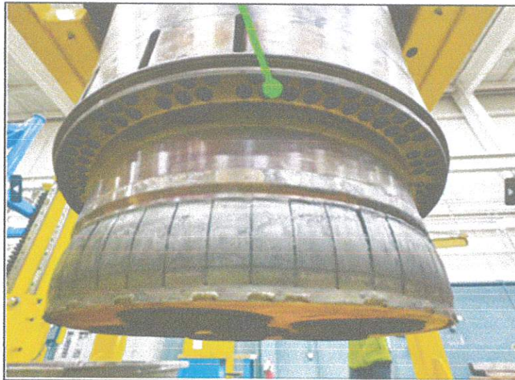
圖3.2.7 壓縮空氣導入口(Head End Module)
