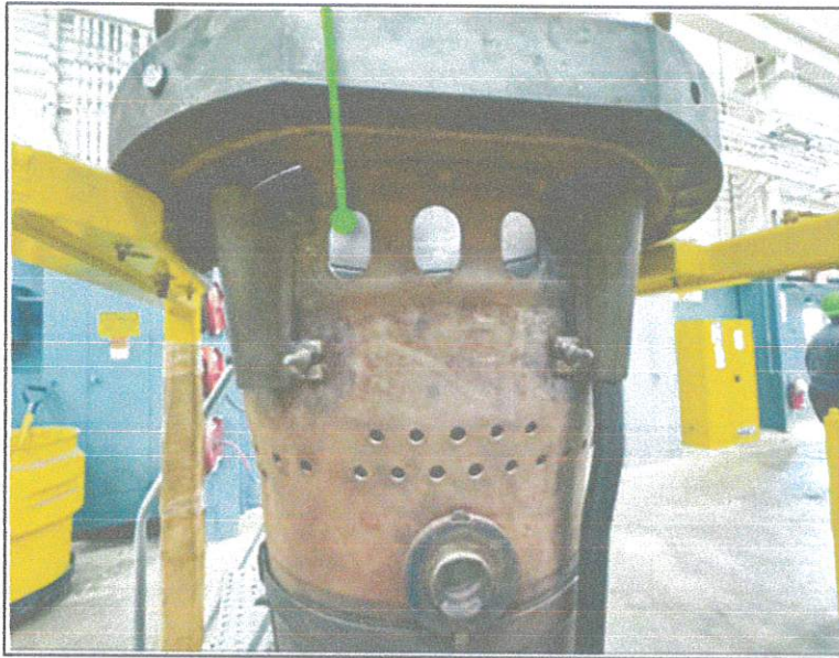
圖3.2.6 壓縮空氣導入口(Unibody Module)
