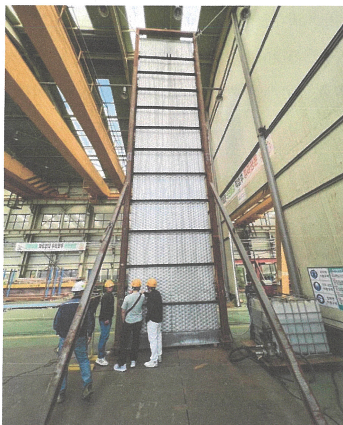
圖(九)集塵板水膜測試
