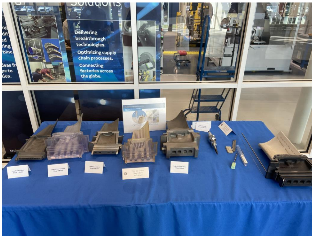
圖 3-21 3D 列印之氣渦輪機氣機葉片
