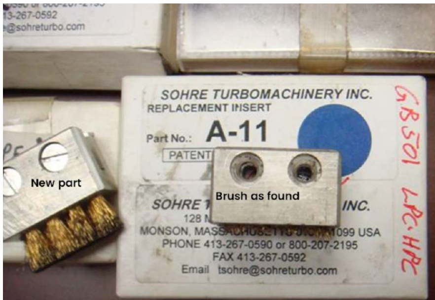
圖 22 接地銅刷 (圖片来源: Bently Nevada 訓練中心資料)
