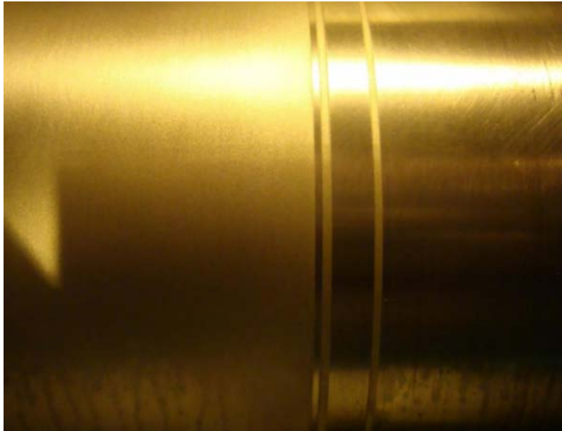
圖 19 軸頸電腐蝕現象 (圖片來源：Bently Nevada 訓練中心資料)
