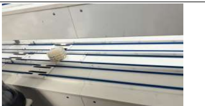
圖 2: Westmead Hospital 自動化實驗室軌道運送培養基至溫箱
